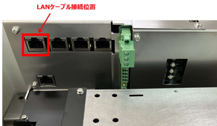
図 4-3 LAN ケーブル接続位置
